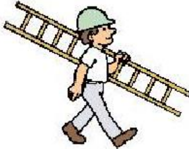
Manera correcta de transportar una escalera
